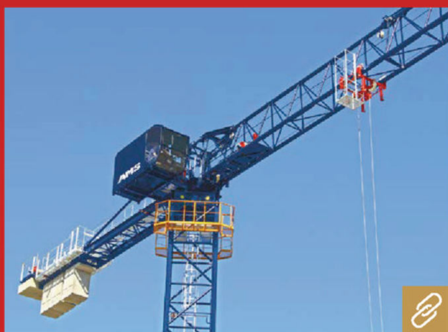
Die neue Generation der AK-Turmdrehkran-Reihe von AMS Kranbau zeichnet sich durch eine neue Fahrerkabine sowie überarbeitete Steuerungstechniken der Dreh-, Katzfahr- und Hubwerke aus. Bild: AMS
